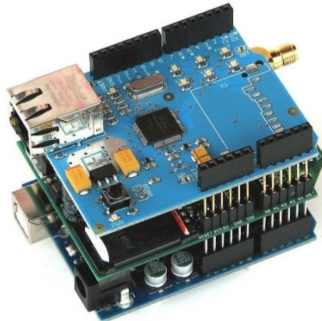
Figura 3. De base Arduino UNO, encima Shield Wifi, encima Shield Ethernet.
